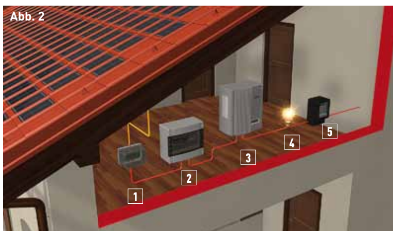
1 Solarschaltkasten 2 Freischaltbox 3 Wechselrichter 4 Verbraucher 5 Einlieferzähler
