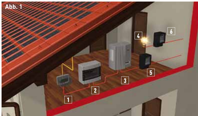
1 Solarschaltkasten 2 Freischaltbox 3 Wechselrichter 4 Verbraucher 5 Einlieferzähler 6 Bezugszähler
